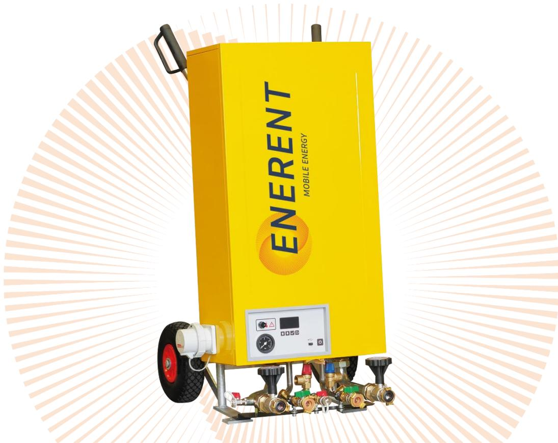
Das Elektroheizmobil kann mit seinem integrierten Wärmetauscher neben dem Heizbetrieb auch zur Warm- und Brauchwasserbereitung herangezogen werden. Hierbei wird es mit dem Heizungsnetz (Heizungsvor- und -rücklauf) und dem Brauchwassernetz (Kalt- und Warmwasser) verbunden.
