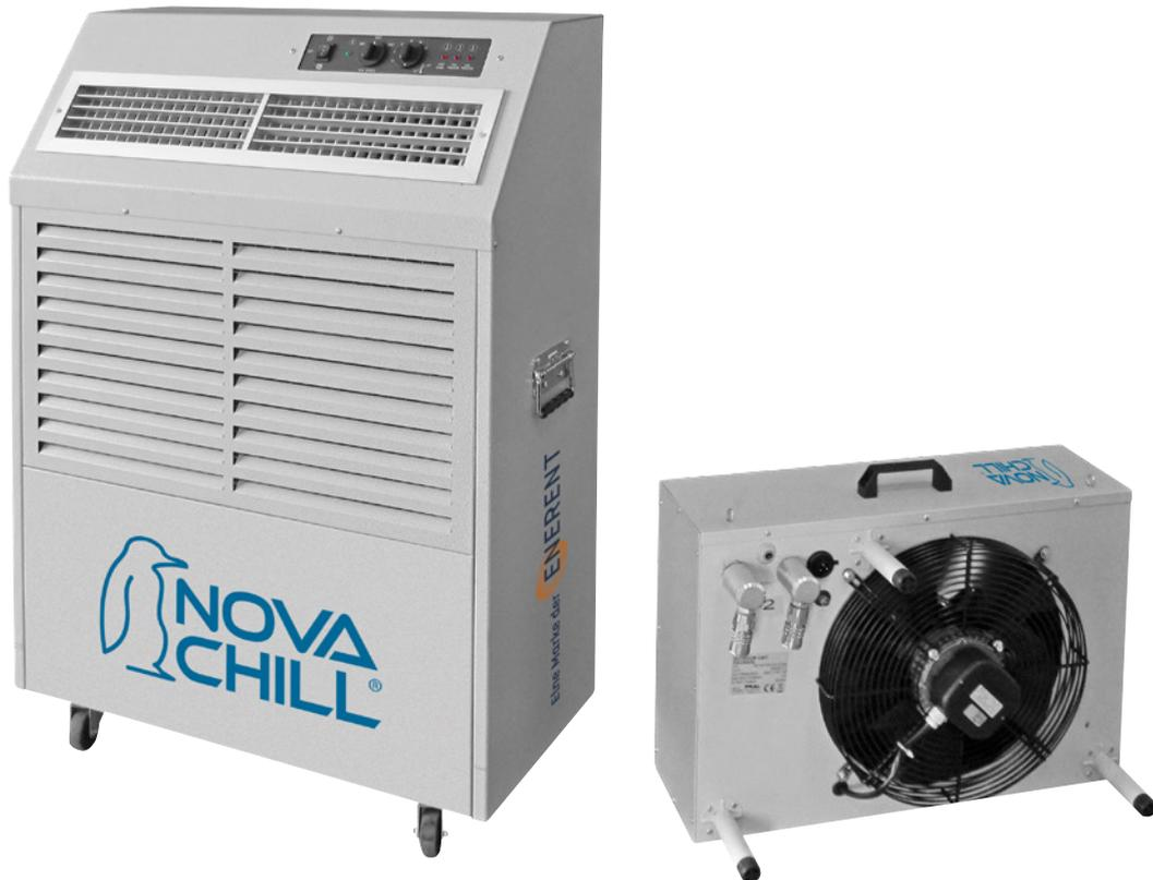
Das Gerät ist ein spezielles Split-Klimagerät, in dem das wärmeleitende Medium ein Gemisch aus Wasser und Glykol ist. Damit ist das Gerät in der Lage, bei bis zu  $-10^{\circ}\text{C}$  Aussentemperatur zu kühlen.
